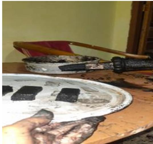
Gambar 1 diatas memperlihatkan proses pencetakan pada briket. Pencetakan briket bertujuan untuk membentuk bahan campuran arang dan perekat menjadi produk akhir yang siap digunakan dan meningkatkan kepadatan briket serta membentuk ukuran dan bentuk yang seragam. Proses pencetakan briket ini menggunakan penggiling daging manual, briket yang di cetak berbentuk kubus.
