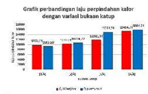
**Gambar 4.1 Perbandingan laju perpindahan kalor dengan variasi bukaan katup**
