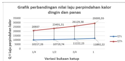
**Perbandingan nilai koefisien perpindahan panas menyeluruh pada fluida dingin dan panas dengan memvariasikan bukaan katup fluida dingin dengan suhu fluida panas 60°C dengan kapasitas fluida masing-masing 70 liter**
