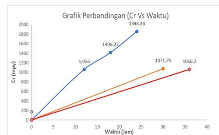
Gambar 4.3 Grafik perbandingan antara waktu dan perubahan laju korosi pengujian pada spesimen (pipa)
