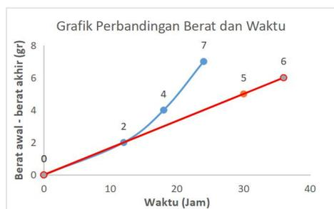
Gambar 4.1 Grafik perbandingan antara waktu dan perubahan berat pengujian pada spesimen.
