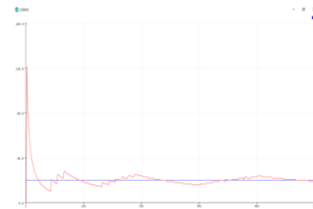
Gambar 4.2 Respon Sistem dengan K_p=18 K_i=169 dan K_d=0,4 .
