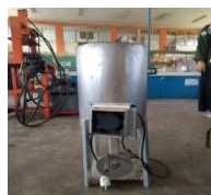
Gambar 2. Rancangan kompor briket biomassa
