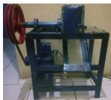
Gambar 2. Prototype Mesin Pemotongan Kerupuk Kulit
