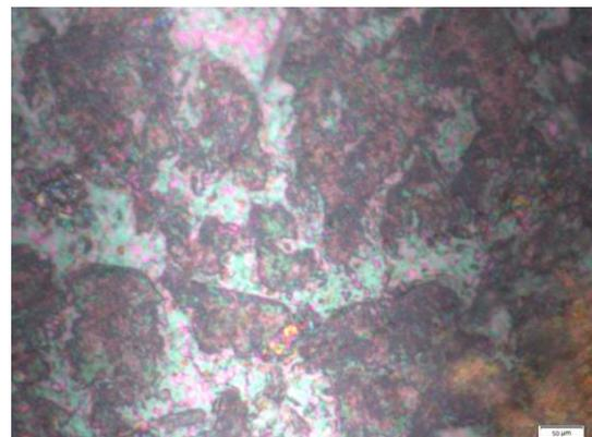
**Gambar 4.** Hasil Uji Metalografi spesimen *Wire Drawing High*
