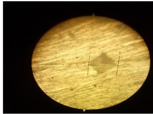
**Gambar 6** Jejak Hasil Uji Kekerasan Vickers Spesimen 2 (*Gemuk + minyak goreng*)
