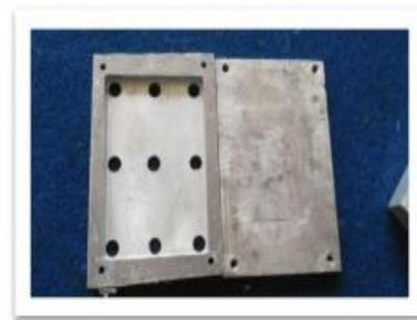
Gambar 3.6 Cetakan specimen kekuatan impact.
