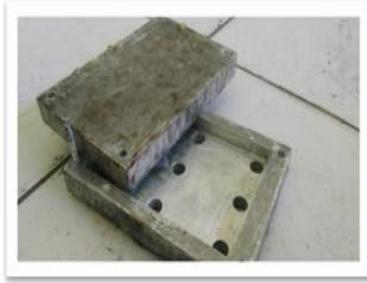
Gambar 3.7 Cetakan spesimen uji lentur.
