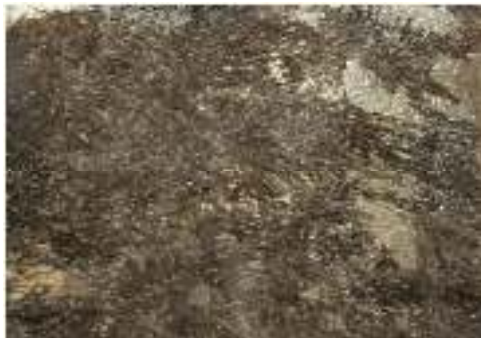
Gambar 8 Permukaan spesimen A1 terkorosi
