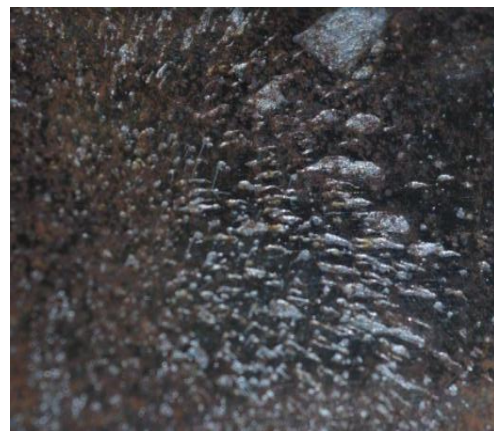
Gambar 4.9 spesimen yang telah dilakukan pengujian selama 48 jam
