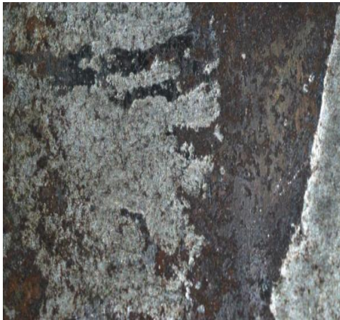
Gambar 4.11 spesimen yang telah dilakukan pengujian selama 96 jam
