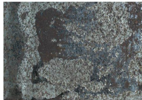
Gambar 4.10 spesimen yang telah dilakukan pengujian selama 72 jam
