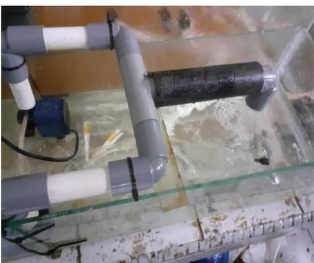
Gambar 2. Alat Uji Korosi Pipa Baja
