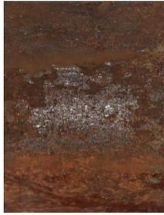
Gambar 10 spesimen pengujian 144 jam
