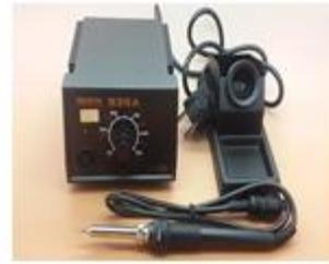
Gambar 3.1 Pengontrol Sumber panas
