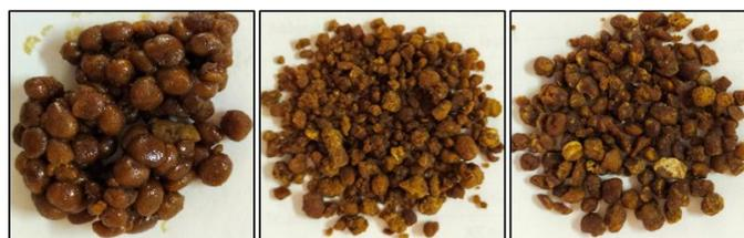
**Gambar 3.2** (a) Hasil Produkbutiran pada bahan pH 6 (*Prilling* 2M), (b) Hasil Produk butiran pada bahan pH 6 (*Prilling* 3M), (c) Hasil Produk dengan wujud butiran pada bahan pH 6 (*Prilling* 4M)
