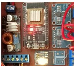
Gambar 1. Pengujian Modul mosfet (led indikator menyala)
