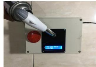
Gambar 2. Pengujian Sensor Gas MQ-2
