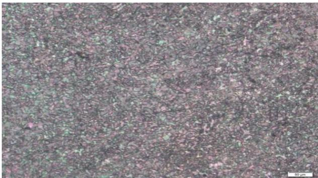
Gambar 1. Hasil Uji Metalografi Spesimen Wire Drawing Dengan Pelumasan
