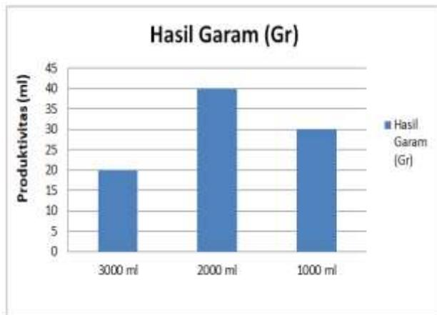
Grafik 3. Produktivitas garam pada variasi volume air laut 3000 ml, 2000 ml dan 1000 ml dengan menggunakan simulator surya.
