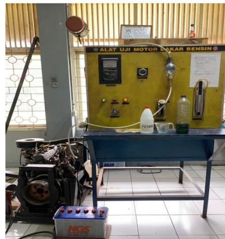
Gambar 1. Alat uji motor bakar bensin
