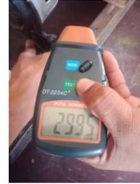
Gambar 9. Pengujian putaran (RPM) pada Generator Sinkron
