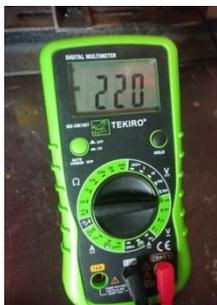
Gambar 8. Pengujian tegangan output Generator Sinkron
