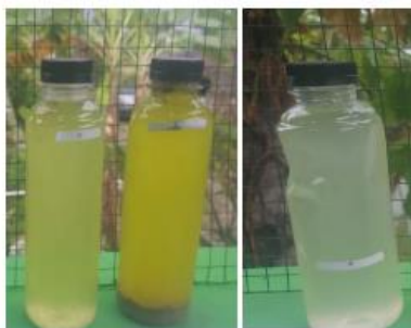
Gambar 2. Hasil Pengolahan Limbah Cair Industri Keripik Singkong (Kanan : Limbah cair sebelum diolah) (Kiri : Effluent hasil pengolahan)
