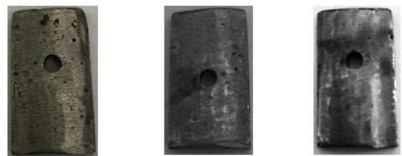
Tampak akhir dari specimen D dengan paparan selama 312 jam pasca pengujian.
