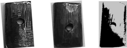
Tampak akhir dari specimen A dengan paparan selama 144 jam pasca pengujian.
