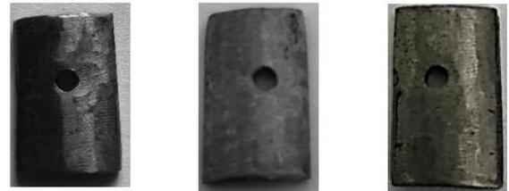
Tampak akhir dari specimen C dengan paparan selama 288 jam pasca pengujian.
