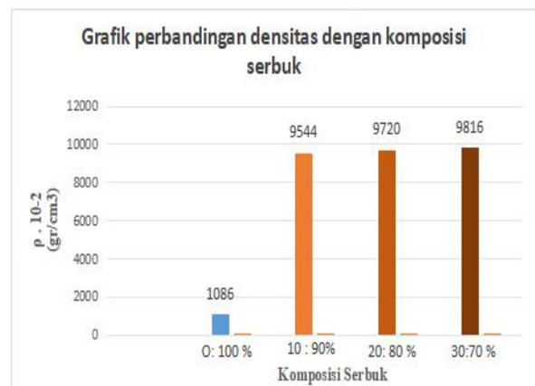
Dari hasil pengujian densitas yang telah dilakukan dengan menggunakan timbangan digital, jangka sorong dan penggaris didapat hasil analisa yang terdapat pada grafik 4.2. didapatkan nilai densitas tertinggi yaitu pada
