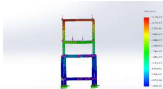
Gambar 5. Hasil Simulasi Displacement 200 N
