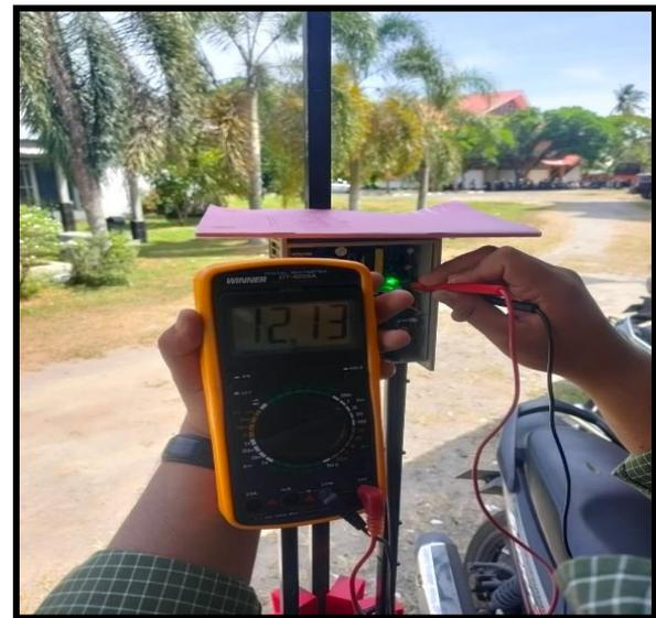
Pengujian Step Down Tegangan dengan melihat tegangan yang sampai pada pin vin dan gnd Step Down Tegangan, dimana nilai tegangan yang sampai adalah sebesar 5,09 V.
