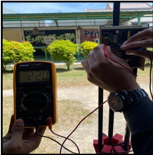
Pengujian Tegangan Kerja Relay dengan melihat tegangan yang sampai pada pin vin dan gnd Tegangan Kerja Relay, dimana nilai tegangan yang sampai adalah sebesar 5,09V.
