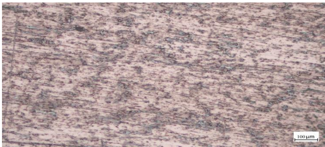
Gambar 3 Struktur Mikro Dengan Perbesaran 100x Tanpa Pelumasan
