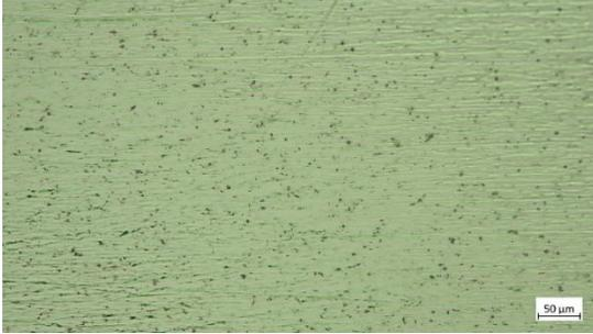
Gambar 1. Struktur Mikro Kawat NiTi Murni Menggunakan Lensa 50 mm
