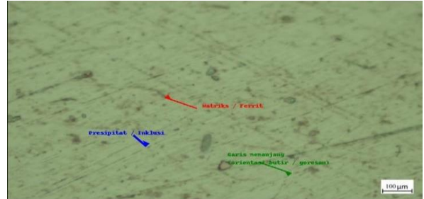
Gambar 1 struktur mikro dengan perbesaran 100 X dengan pelumasan oli
