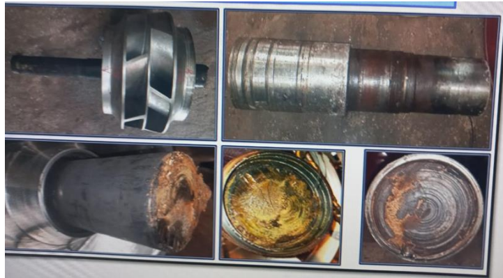
Gambar 1. Poros Pompa ZVV Patah Akibat Fatigue
