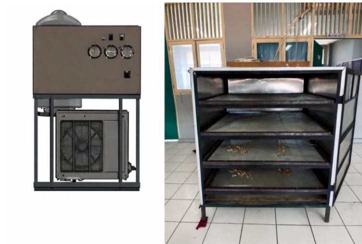
Gambar 1. Pengeriing dengan sumber pemanas dari panas terbuang kondensor AC
