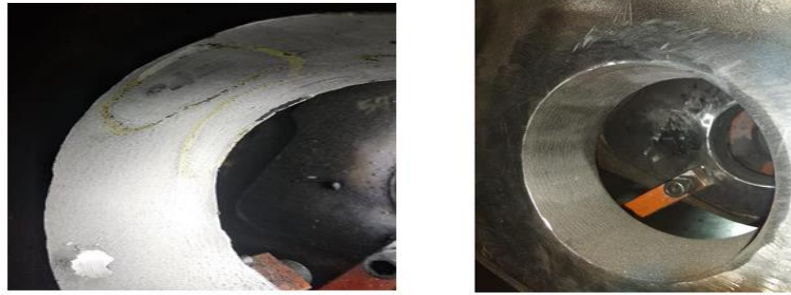
Gambar 2. Hasil Magnetik Partikel Inspeksi After Maching
