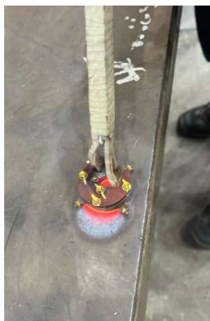
Gambar 3. 7 Warna Proses Pemanasan
