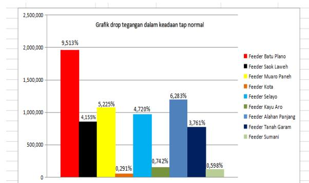
Berdasarkan hasil perhitungan drop tegangan transformator daya dengan kapasitas 20 MVA dengan tegangan kirim 20,6 kV dan 60 MVA 20,7 kV dalam keadaan tap normal dengan drop tegangan tertinggi terdapat pada Feeder Batu
