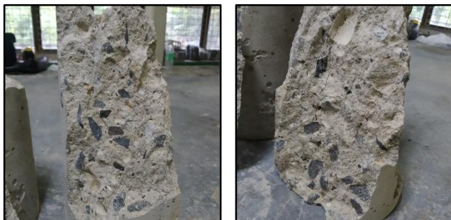
Gambar 3. Bentuk Kehancuran Sampel Beton
