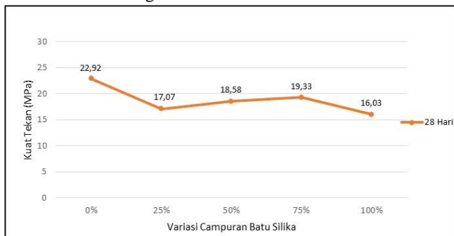
Gambar 2. Diagram Kuat Tekan Beton Umur 28 Hari
