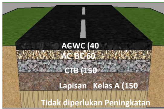
Gambar 1 Potongan Melintang Perkerasan Lentur
