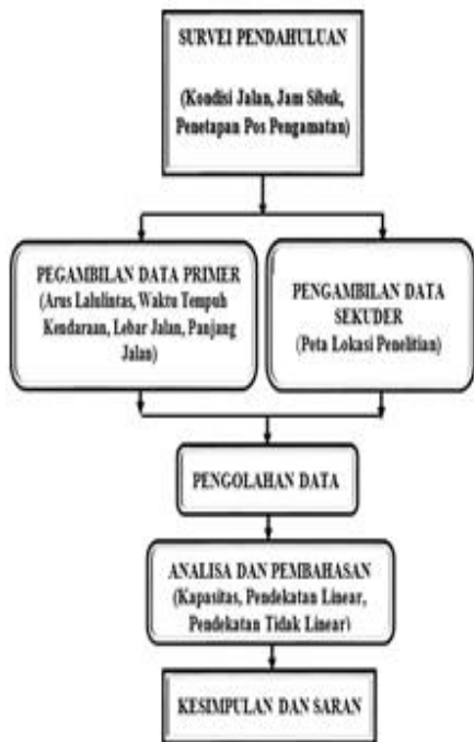
Gambar 3. Langkah Kerja Perhitungan Kapasitas dan Tingkat Pelayanan Jalan Luar Kota
