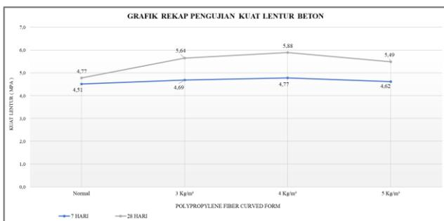
Gambar 2. Hasil Pengujian Kuat Lentur Beton
