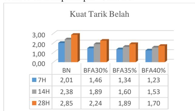
Gambar 2. Rekap Pengujian Kuat Tarik Belah Beton
