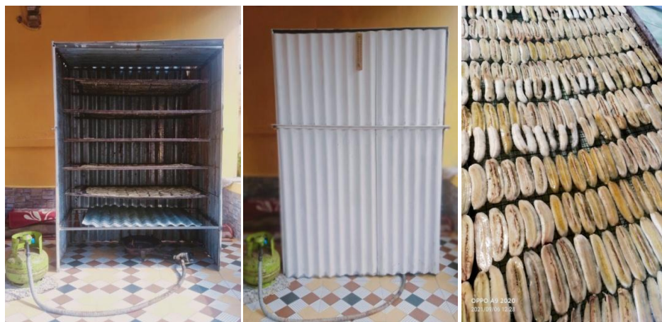
Gambar 2. Pengujian rak pengering dengan sistem pemanas dari kompor elpiji
