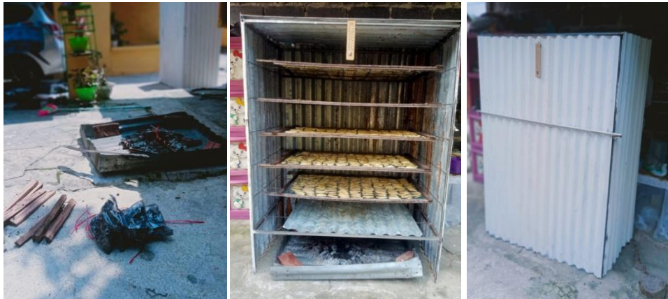
Gambar 3. Pengujian rak pengering dengan sistem pemanas dari panas bara arang kayu
