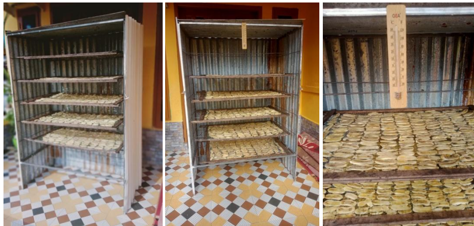
Gambar 1. Pengujian rak pengering dengan sistem pemanas sinar matahari
