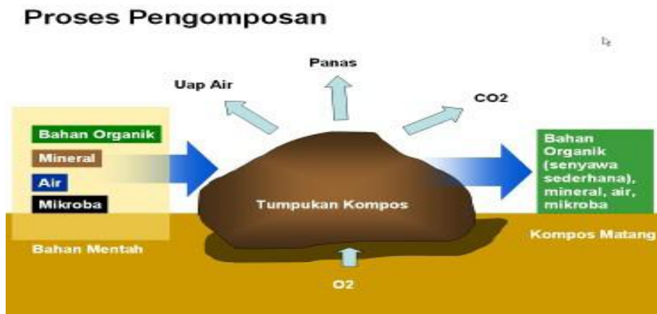
Gambar 1. Proses Umum Pengomposan Limbah Padat Organik (dimodifikasi dari Ryak, 1992)
