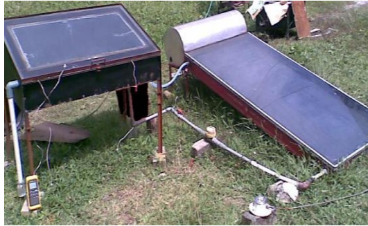
Gambar 1. Foto alat uji destilasi surya menggunakan kolektor pemanas
